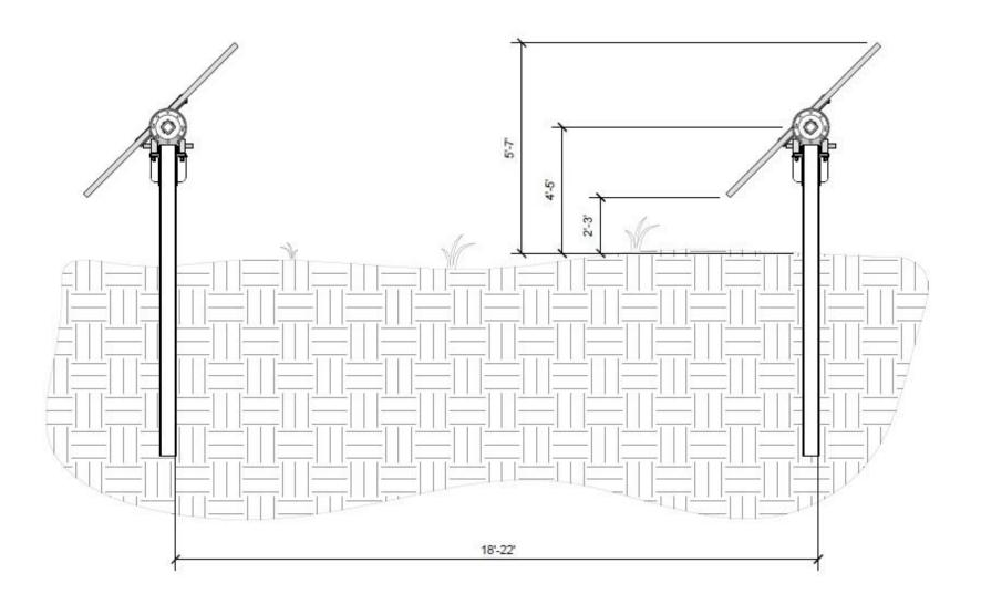
2 TYPICAL TRACKING ARRAY - SIDE ELEVATION SP2.2 SCALE: NTS APPLICANT'S SITE PLAN
